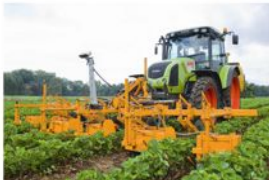
Lenkung mit Stereokameras Agrocom Eyedrive
