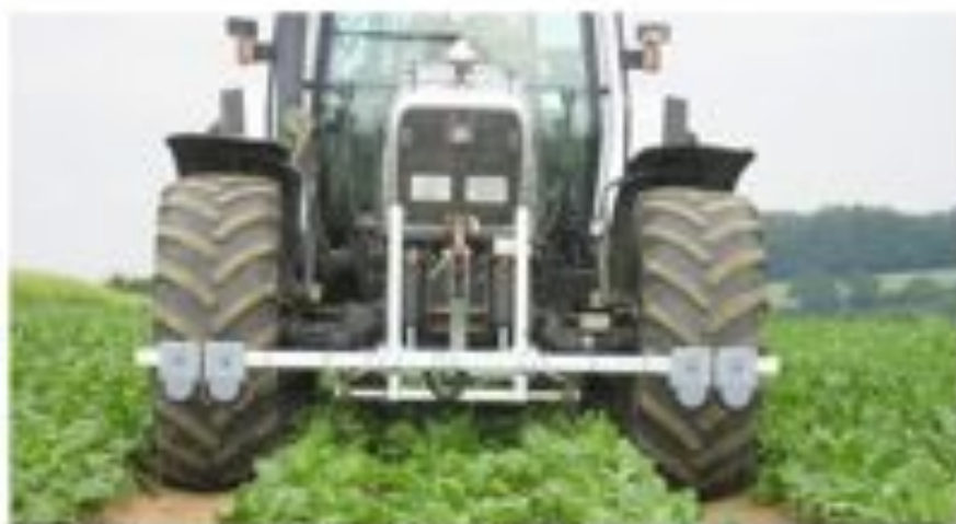
Lenkung mit Ultraschallsensoren Reichardt PSR Sonic
